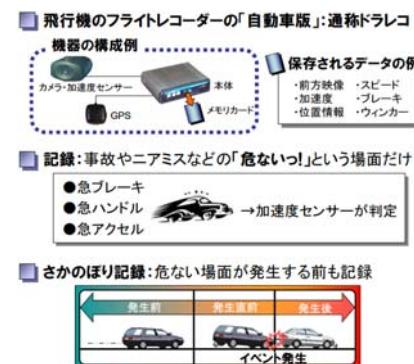
■ ドライブレコーダの映像は、実際のトラック事故やヒヤリハットの実態がわからることから、具体的に「何が要因であったのか」「どのような状況であったのか」「運転者は何を見落としたのか」など、事故の危険性の要因を実際の映像で確認することができます。また、デジタルタコグラフの運行記録などとあわせると、どこでスピードを出していたのか、ブレーキを踏んだのかなどがわかります。
